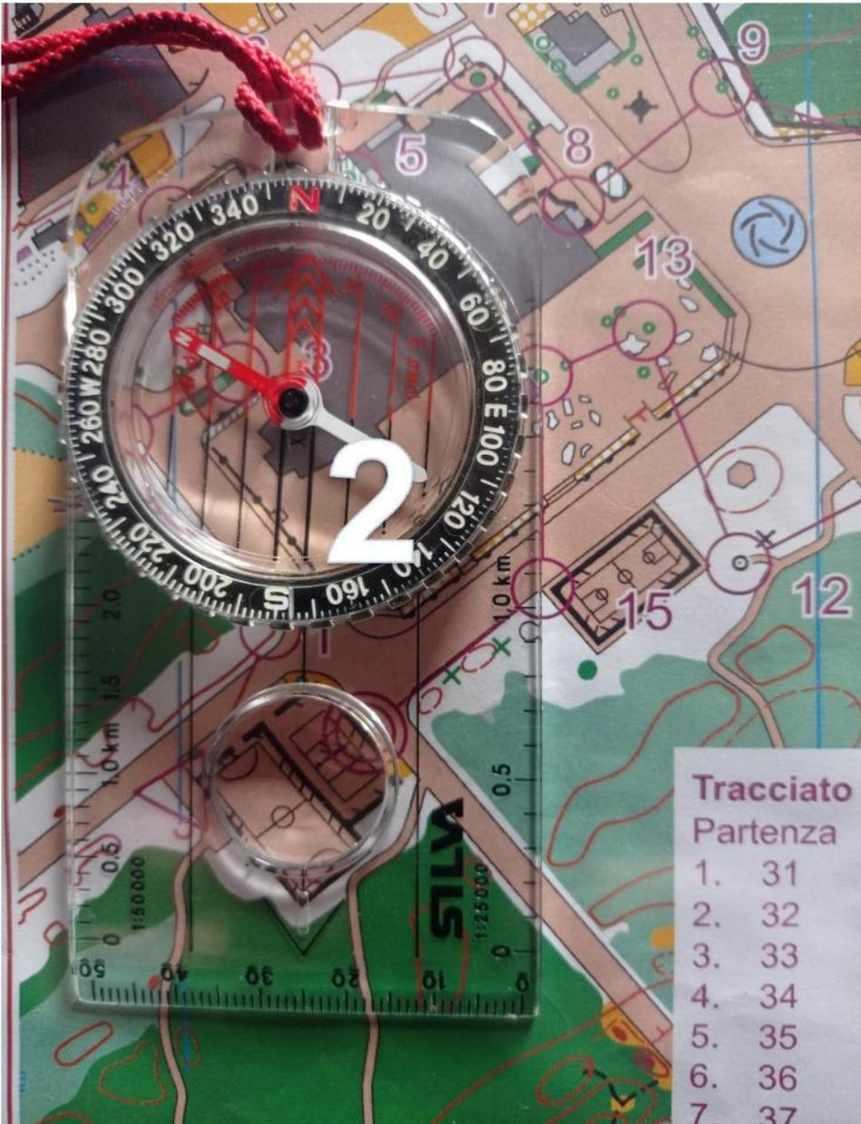
3. Ruotare carta e bussola fino a quando la freccia che indica il Nord non si sovrappone alla freccia di orientamento.
