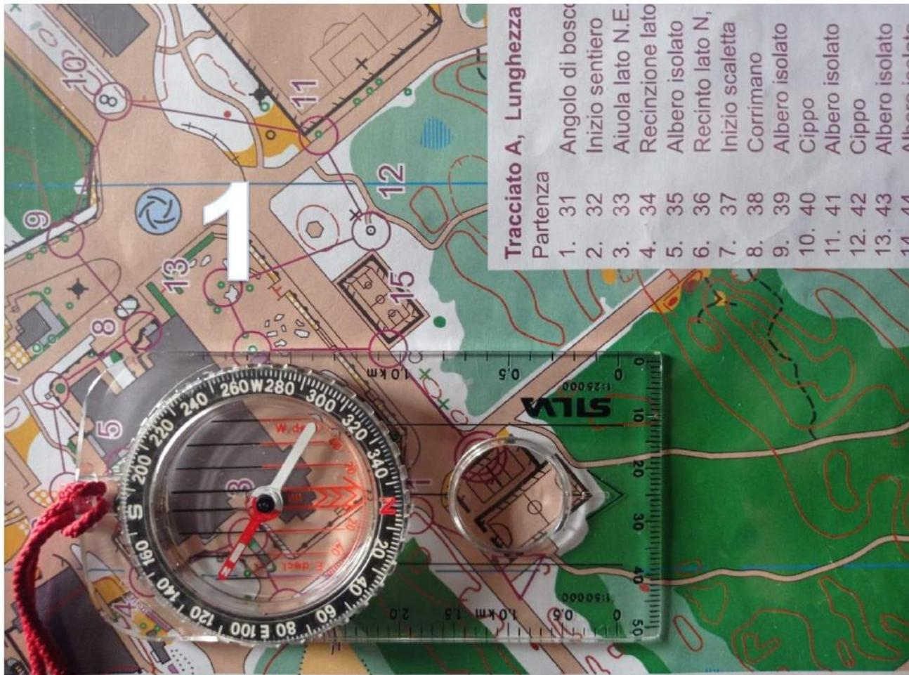
2. ruotare la ghiera fino a quando la freccia di Orientamento punta al Nord della carta
